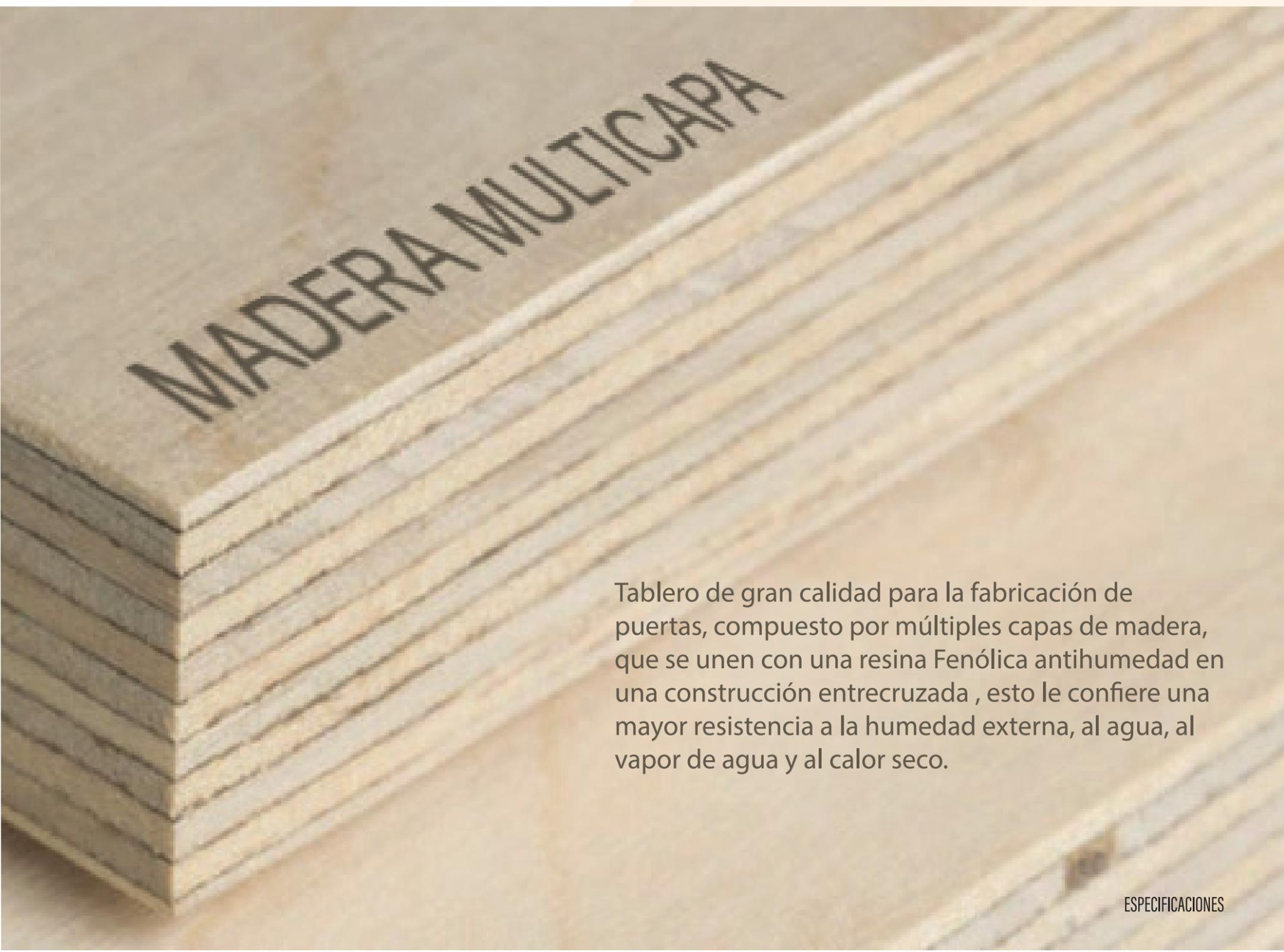
Tablero de gran calidad para la fabricación de puertas, compuesto por múltiples capas de madera, que se unen con una resina Fenólica antihumedad en una construcción entrecruzada, esto le confiere una mayor resistencia a la humedad externa, al agua, al vapor de agua y al calor seco.
